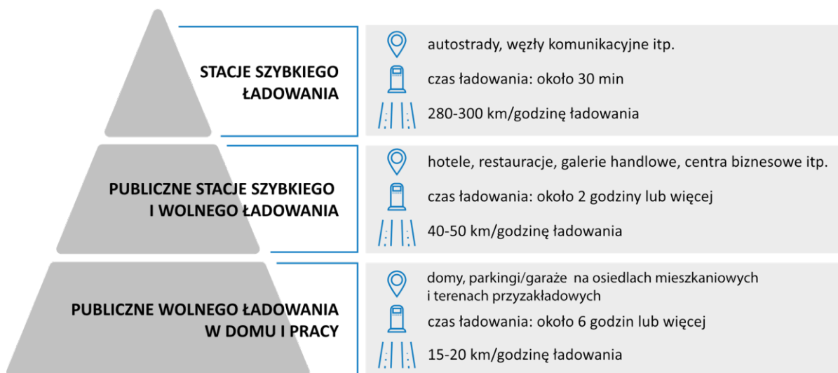
Rysunek 16: Mix infrastruktury ładowania pojazdów elektrycznych
